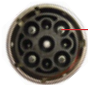
Varovalo za zaščito pred električnim udarom na vtiču JUICE CONNECTOR (m)
