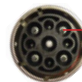
Προστατευτικό αφής από ηλεκτροπληξία στο βύσμα JUICE CONNECTOR (m)
